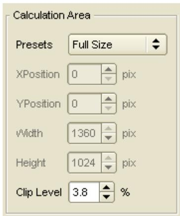
Die Einstellungen für die **Berechnungsfläche** können in den [Programmeinstellungen](#)<sup>[60]</sup> gesetzt werden. Während einer **Messung der Strahlqualität** ( $M^2$  oder Divergenz) wird die Automatische Berechnungsfläche aktiviert, um eine effektive Rauschreduktion zu ermöglichen. Ebenso können Reflexionen und Artefakte durch Filter, Linsen oder andere optische Elemente unterdrückt werden.
