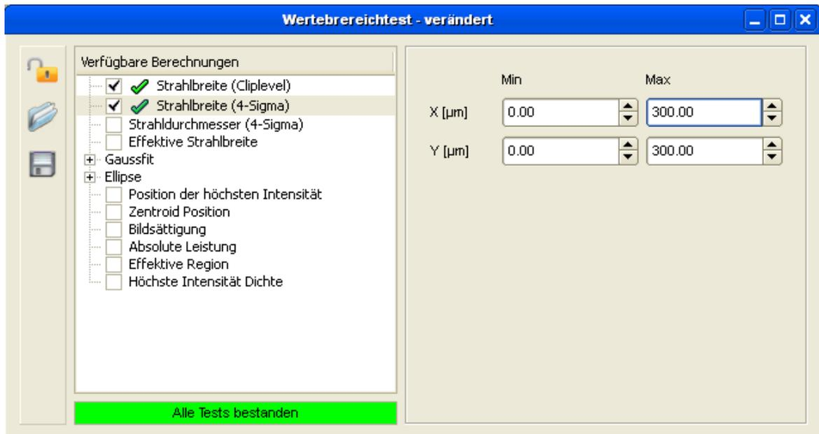
Mit der ersten Installation des Camera Beam Profilers, sind alle Testparameter entsperret (frei bedienbar). Um sie zu sperren, klicken Sie den "Sperrere Testparameter"-Button und wählen Sie ein Passwort.
