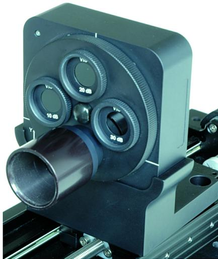
Alternativ kann eine Blende (im Beispiel eine [SM1D12](#)) auf den SM1BC-Adapter montiert werden. Dies vermeidet ebenfalls ungewünschtes Umgebungslicht. Es ist darauf zu achten, dass der Strahl zu keiner z-Position abgeschnitten wird - das könnte Einfluss auf die Messung haben. Die Größe der Iris sollte an der Stelle mit der größten Strahlbreite gesetzt werden.
