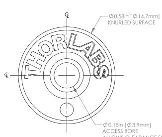
ALLOWS CLEARANCE FOR 5/64" BALL DRIVER OR HEX KEY
