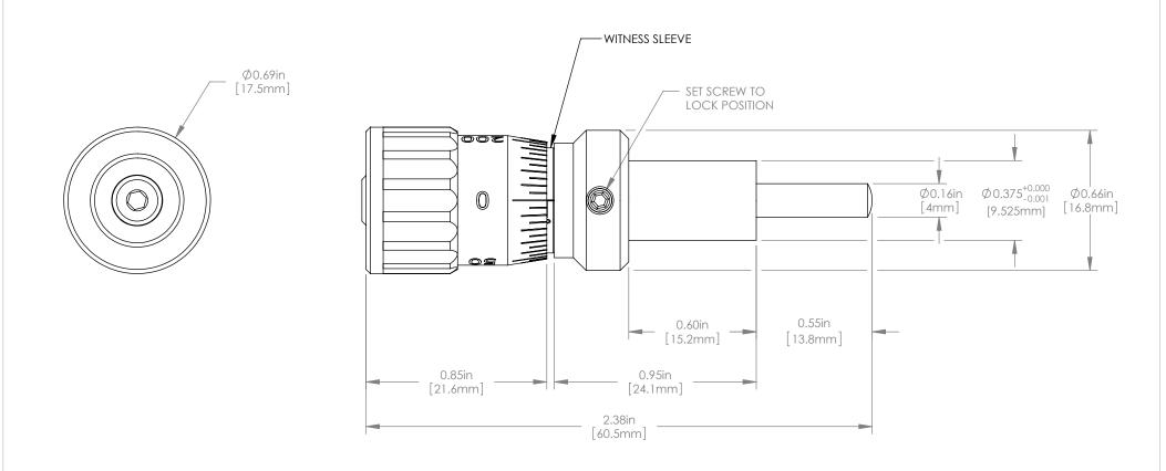
NOTE: KNOB ENGRAVED FOR 250µm PER REVOLUTION SLEEVE IS ENGRAVED TO 10.5mm
